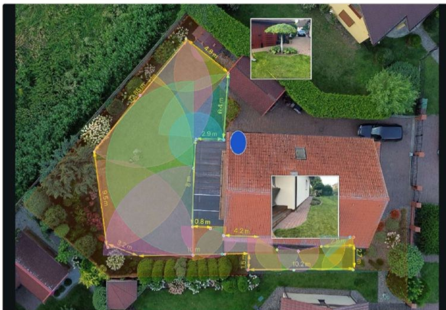
Rys. 1 — Projekt rozmieszczenia stref nawadniania na podkładzie z lotu ptaka. Kolorowe pola to zasięgi zraszaczy.
